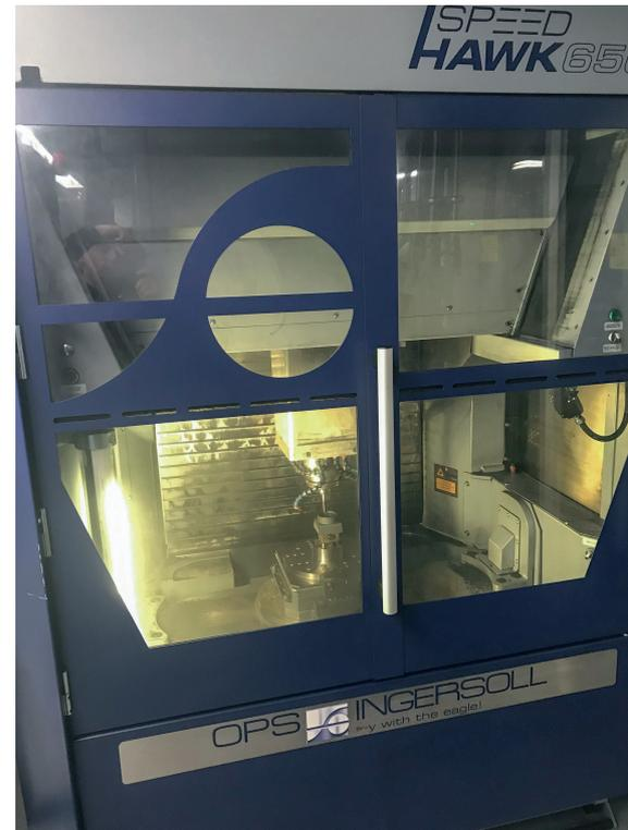
**Ort des Geschehens:** Auf der Elektrodenfräsmaschine 'OPS-Ingersoll Speed Hawk 650' als Teil einer automatischen Fertigungszelle bewährt sich das Werkzeug von Hufschmied vielfach
